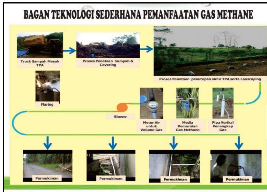
Gambar 4.3 Bagan Teknologi Sederhana Pemanfaatan Gas Metana TPA Talangagung
